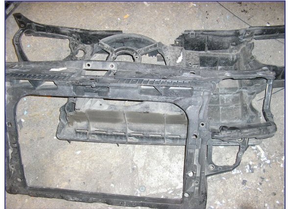
Ejemplos de soporte delanteros de radiador en PP + FV y otro de PA +FV
